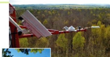
A Tour de mesure de la forêt de Hesse et capteurs permettant le suivi des échanges gazeux entre l'écosystème et l'air.
